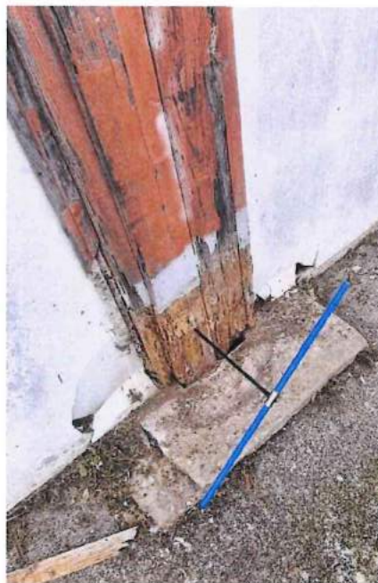
Carotaggio con succhiello di Pressler su pilastro N. 6
